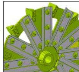
DOIS POTENTES ROTORES COM 12 FACAS, 12 LANÇADORES E POTENTES PROPULSORES EM CADA ROTOR GARANTINDO UMA EXCELENTE UNIFORMIDADE DE CORTE E LANÇAMENTO
