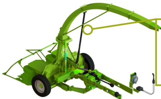
**TRANSPORTE SEGURO** - Barra estabilizadora central de recolhimento e **transporte da bica**, trazendo mais conforto e segurança no traslado da máquina.
