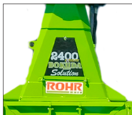
TAMPA CENTRAL DE ABERTURA DE INSPEÇÃO PARA ACESSO INTERNO À MÁQUINA EM CASO DE EMBUCHAMENTO
