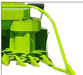
TOMBADOR LATERAL COM OPÇÃO DE DESLOCAMENTO, POSSIBILITANDO RECOLHIMENTO EXCEPCIONAL DO MILHO OU PLANTA CAÍDA
