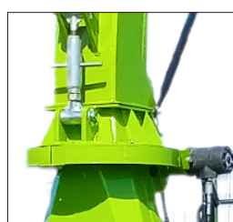
OPÇÃO DE REGULAGEM DO TAMANHO DE CORTE DA SILAGEM
