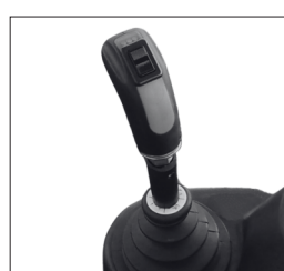
JOYSTICK QUE PERMITE AO OPERADOR CONTROLE AO HIDRÁULICO FRONTAL, GIRO DA BICA DE DESCARGA E MOVIMENTO DO QUEBRA-JATO À PARTIR DO TRATOR
