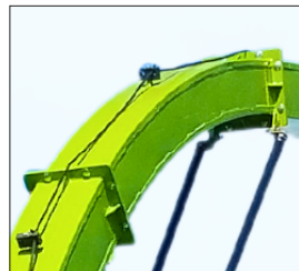
TOMBADOR LATERAL COM OPÇÃO DE DESLOCAMENTO, POSSIBILITANDO RECOLHIMENTO EXCEPCIONAL DO MILHO OU PLANTA CAÍDA
